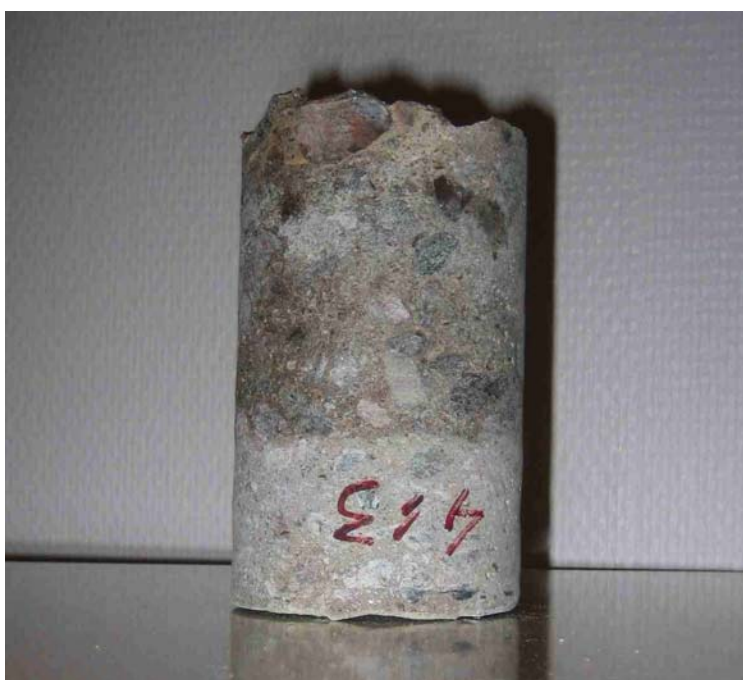
Figur 7:7. Provcylinder för vidhäftningsmätning.
