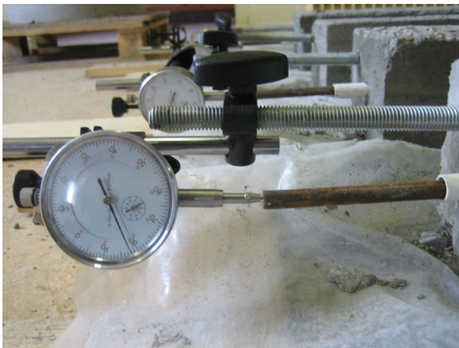
Figur 4:14. Detalj av mätning av lång balk.
